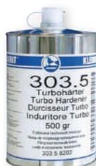
**KLE029** Flacon de 500 g. Permet de faire passer la Supracolle 303 du classement D3 au classement D4 pour le collage extérieur. Dosage à 5 %, le mélange obtenu est utilisable pendant 24 heures. Pour les colles **KLE020**, **KLE021**, **KLE022**, **KLE023** .....68,00 €
